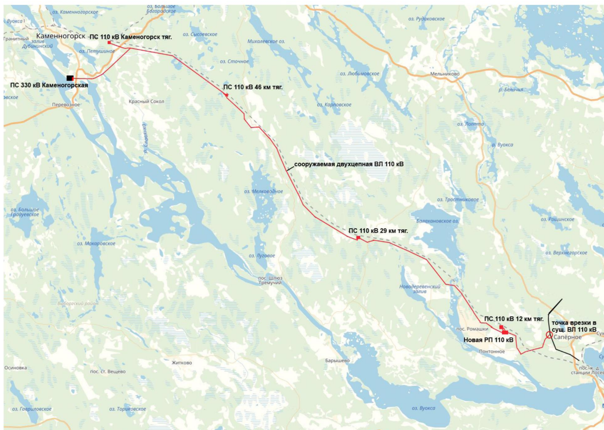
Рисунок 2 – Карта – схема прохождения трассы, сооруженной двухцепной ВЛ 110 кВ от ПС 330 кВ Каменногорская до точки врезки в ВЛ 110 кВ Громовская 3,5 и размещения площадок, сооружаемых ПС 110 кВ Каменногорск – тяговая, ПС 110 кВ 12 км, ПС 110 кВ 29 км, ПС 110 кВ 46 км, новой РП (ПС) 110 кВ «12 км»
